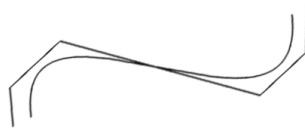
图 3-27 带有控制多边形的 B 样条曲线
