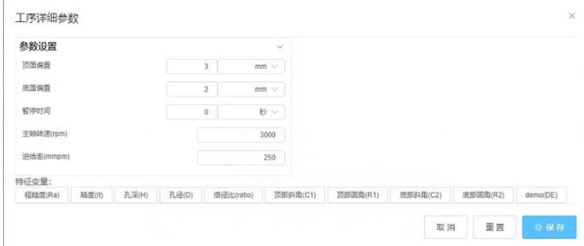
选中特征策略表格 PLAN-B 方案添加的工步，重复进行上述操作完成 PLAN-B 方案的孔铣工步设置。
