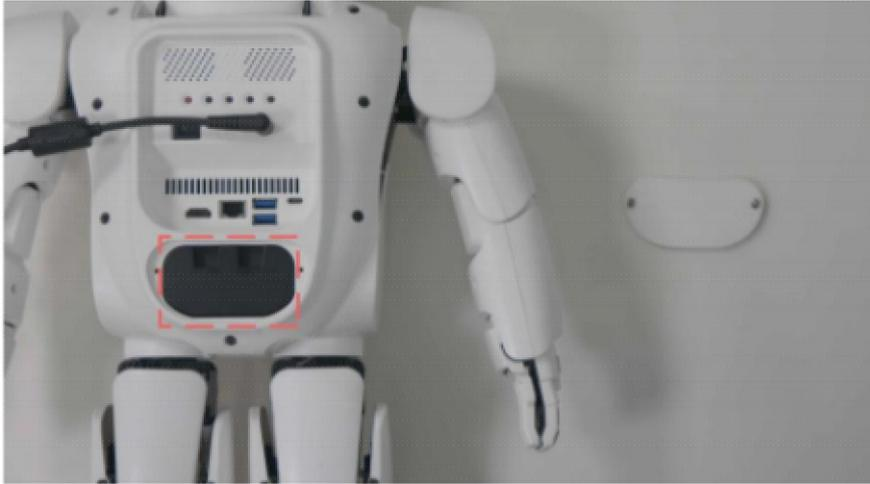
4. 装上电池盖，拧紧两颗螺丝固定。
