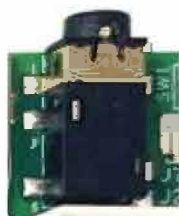
图15. OharmPi_emb_3568_v2 3.5mm耳机接口示意图
