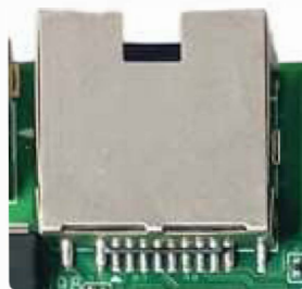
图10. OharmPi_emb_3568_v2 RJ45接口示意图
