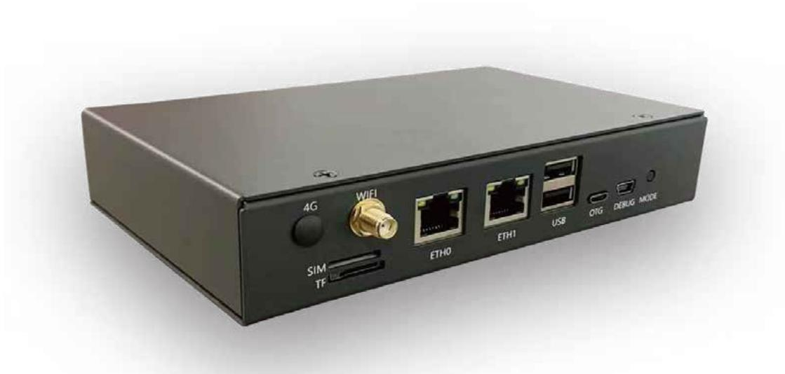
**祯欣ICG200** 系列物联网网关是祯欣互联自主研发设计、综合运用边缘计算、大数据、人工智能等前沿技术，实现自动适配大部分工业通讯协议，实时采集设备多种运行数据。解决目前制造业企业**设备接口、网络协议不统一**问题；解决数据从采集到**数据应用**问题；解决 OT 到 IT 的数据**高效协同**问题。
