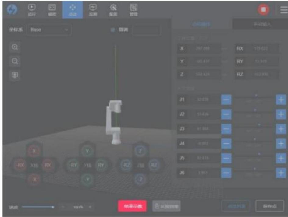
开启零力示教后,按钮显示为红色【结束示教】,可以自由拖动机器人,当机器人接近安全空间范围边缘或安全边界,会感觉到一个反方向的力,此时再继续往安全边缘运动会导致机器人报错。因此请在安全范围内拖动,点击【结束示教】即退出零力示教状态。反抗力的目的是告诉用户当前的位置或速度接近极限,从而防止机器人违反该极限;不过,如果用户对机器人施加足够的力量,该极限是可以被违反的,力的大小对着机器人手臂不断接近极限而增大。
